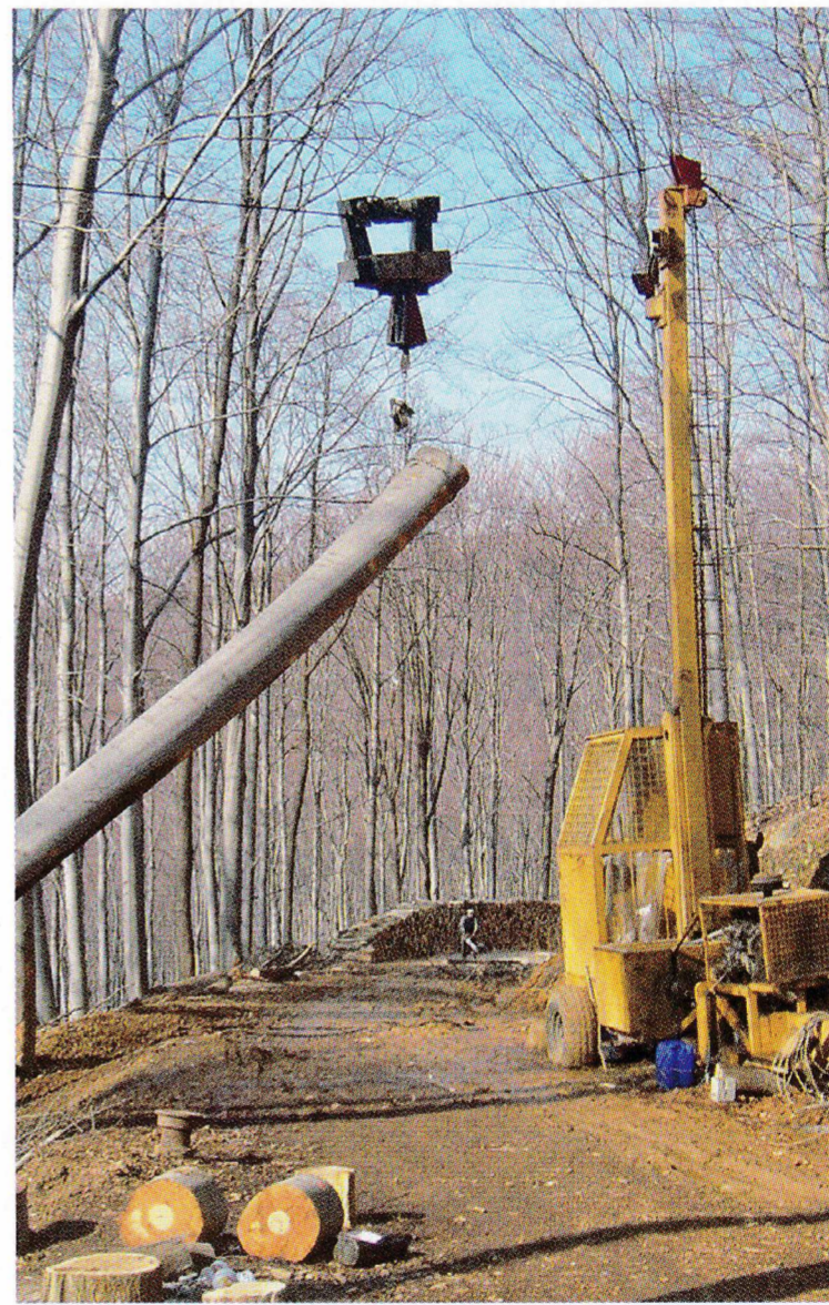
Vontatott és traktorra szerelt kötélpálya árboc
